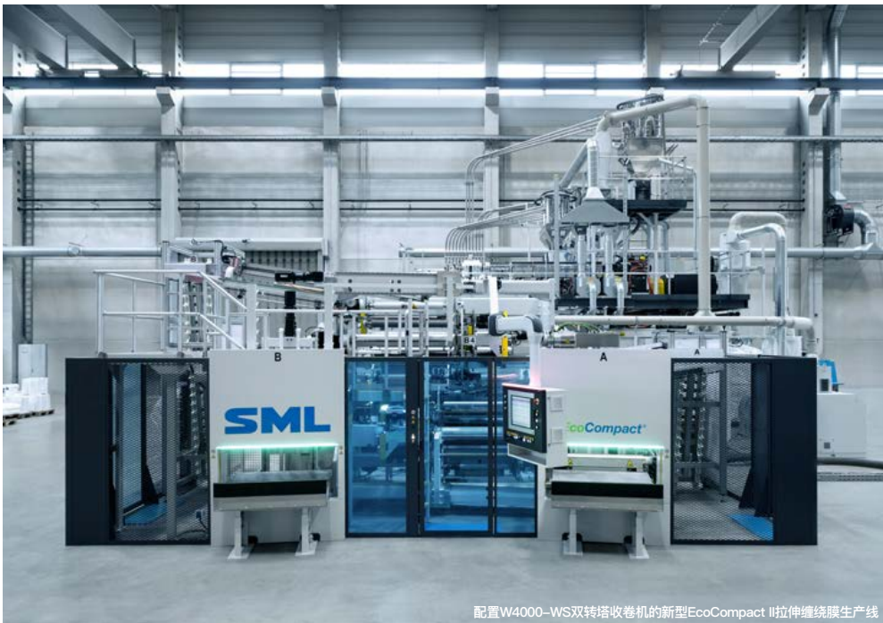
配置W4000-WS双塔收卷机的新型EcoCompact II拉伸缠绕膜生产线
